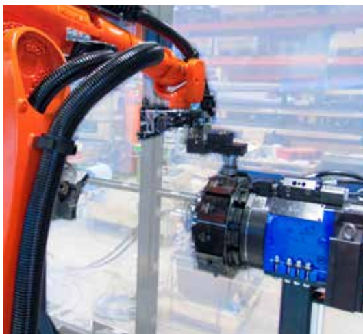
...zum ‚Leonardi Line‘-Revolver von Baruffaldi und setzt es (chip-abgesichert) vertikal in die 12-Uhr-Station ein...
