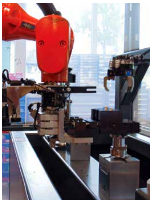
Der (Kuka-)Roboter auf der ‚mobileCell‘ nimmt am Warehouse ein ‚QuickLock-Werkzeug auf, das AGV fährt mit ihm...
